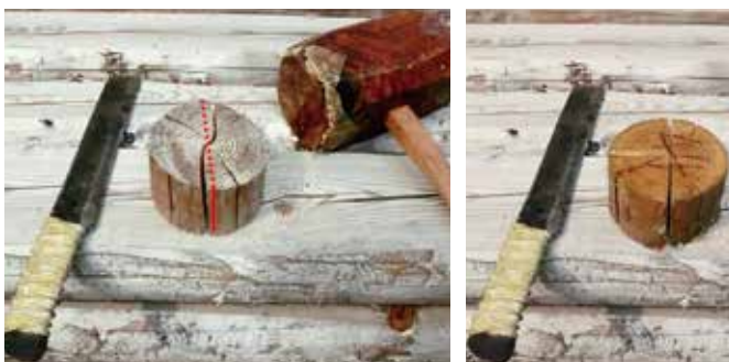
(左：加撃側、右：測定側 点線が基準線) 写真-2 割裂試験
