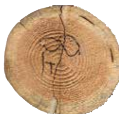
(左：加撃側、右：測定側 点線が基準線) 写真-2 割裂試験
