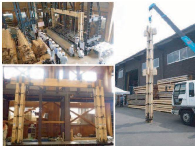
写真-2 岐阜県産ヒノキ材ラーメン構造の開発実験
